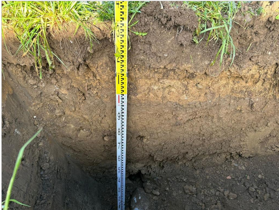
Foto 3: Blick auf SCH 1. Unter dem umgelagerten Oberboden folgt schluffige Auffüllung bis etwa 0,35 m u. GOK.
