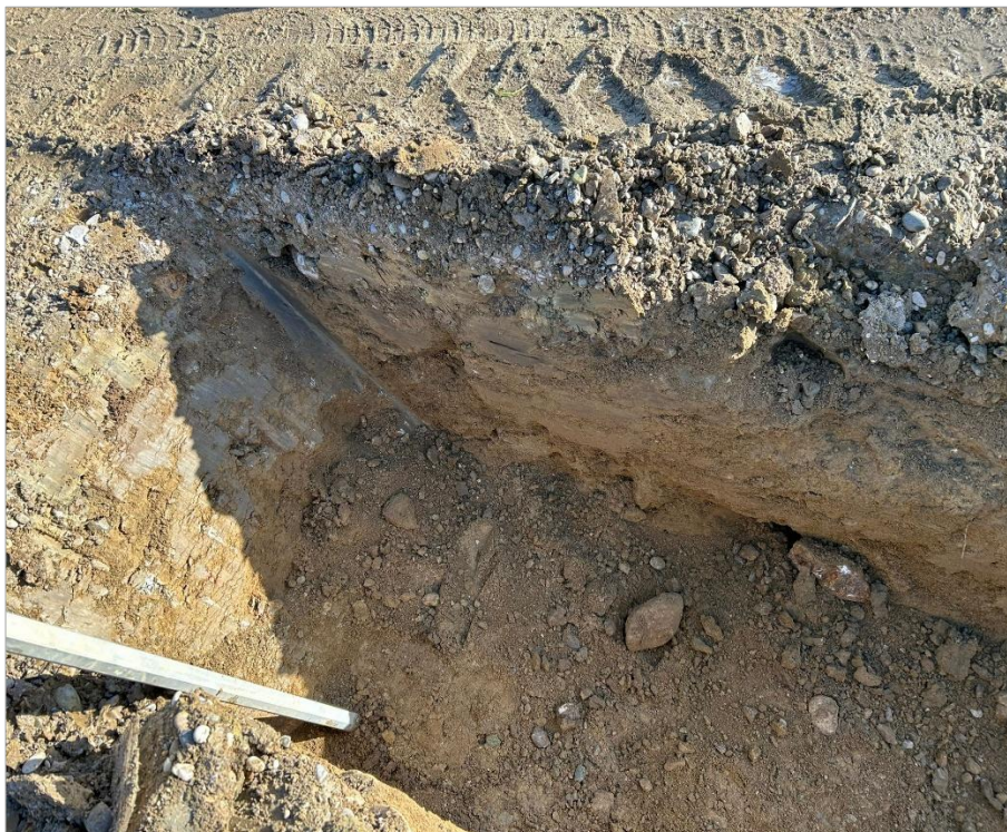
Foto 12: Blick auf SCH 4. In der schluffigen Auffüllung bis ca. 0,25 m u. GOK wurden vereinzelte Asphaltreste (ca. <1%) festgestellt.
