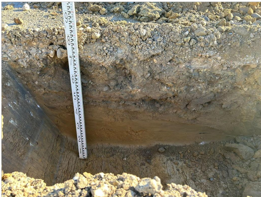
Foto 14: Blick auf SCH 5. In der schluffigen Auffüllung bis ca. 0,5 m u. GOK wurden vereinzelt größere Asphaltreste (ca. < 1 %) angetroffen
