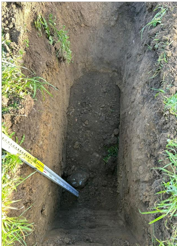
Foto 6: Blick auf SCH 1. Im umgelagerten Oberboden wurden vereinzelt Asphaltreste (ca. < 1 %) und im überschütteten Oberboden vereinzelt Ziegelreste (ca. < 1 %) erkundet.
