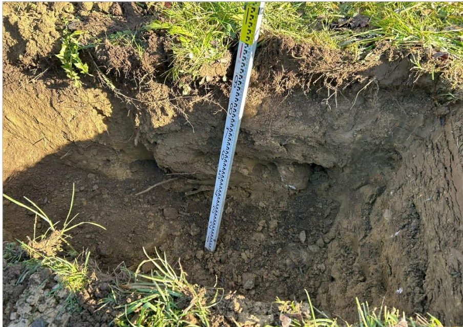
Foto 9: Blick auf SCH 3. Im umgelagerten Oberboden bis ca. 0,4 m u. GOK wurden sehr vereinzelt Ziegelreste (ca. < 1%) angetroffen.
