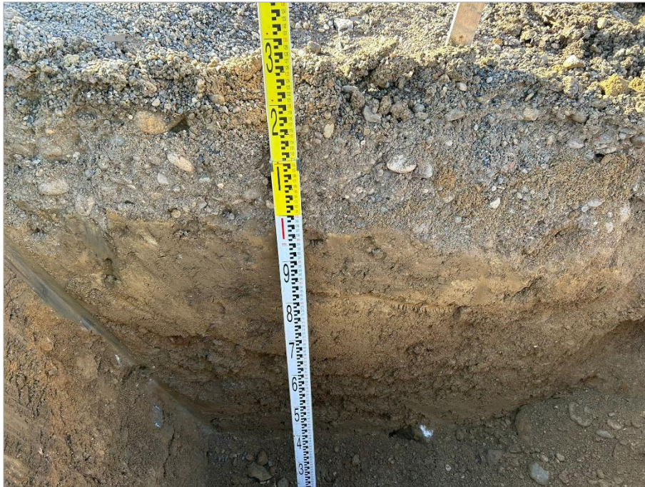
Foto 7: Blick auf SCH 2. Aufgefülltes Tragschichtmaterial bis etwa 0,25 m u. GOK, darunter folgt schluffige Auffüllung bis etwa 0,5 m u. GOK.
